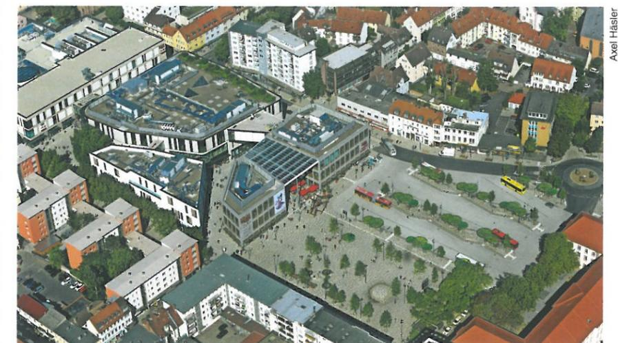
Abb. 3: ZOB am Freiheitsplatz nach dem Umbau mit neuer Anordnung der Bussteige als „Sägezähne“.
